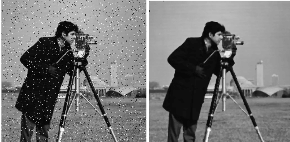
1.11. ábra. Só és bors zajjal terhelt kép (balra) és medián szűrt változata (jobbra).
