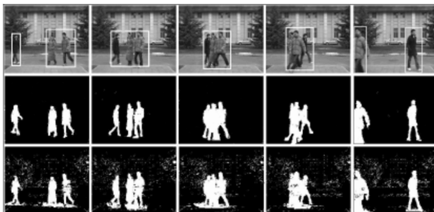
5.15. ábra. A gauss háttérmodell alapú mozgásszegmentálás elve. A középső sorban a variancia alapú különbségküszöbözéssel előállított képek látszanak, míg az alsó sorban az egyszer konstans küszöbvel készített eredmények.
