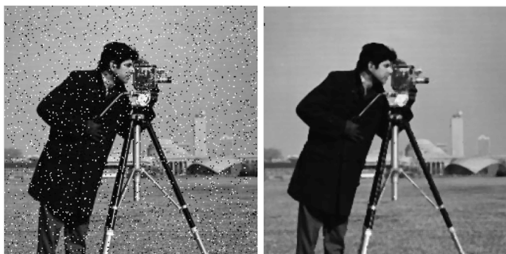
2.11. ábra. Só és bors zajjal terhelt kép (balra) és medián szűrt változata (jobbra).
